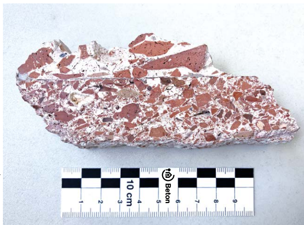
Bild 1: Zweilagiges Bruchstück eines römischen Betons mit Sieblinien unterschiedlicher Korngröße und Ziegelsplitt als Gesteinskörnung
