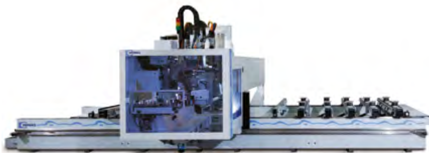
Maschinenbett aus NANODUR® Beton – HOMAG Sorb Tech®
